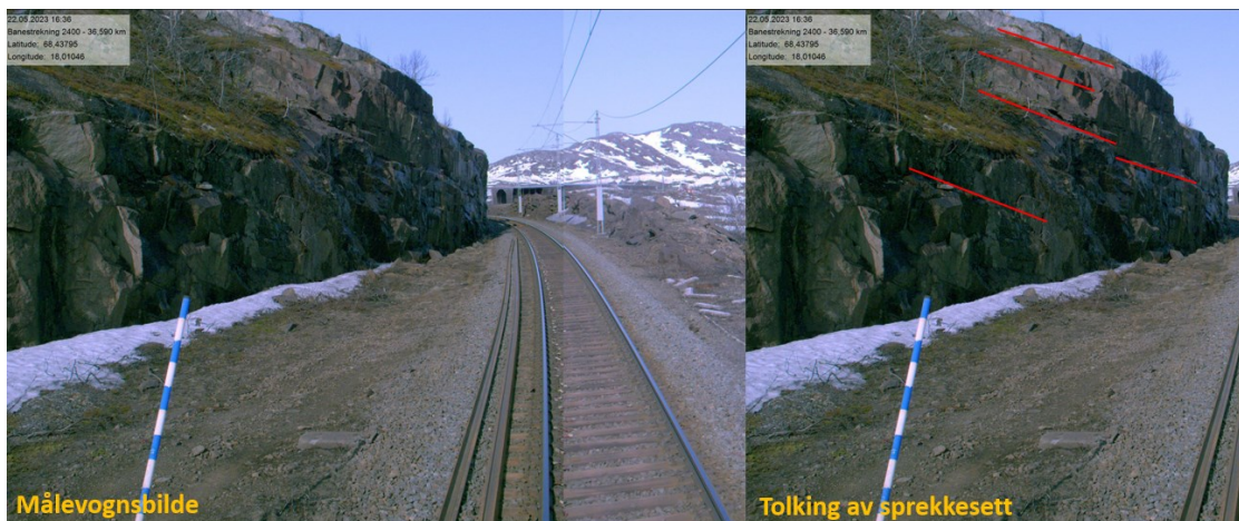
Figur 5.1 Flattliggende sprekkesett, tolket fra målevognsbilder.
