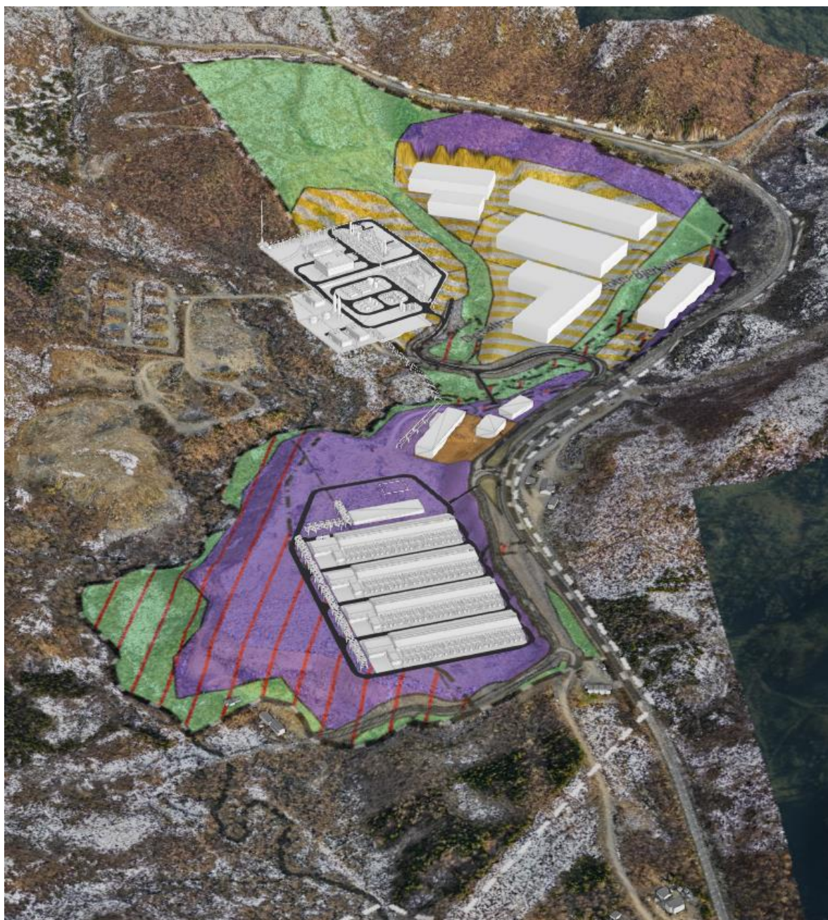
Figur 2-3: Skisse som viser foreslått arealbruk med hensyn til gjeldende reguleringsplan (Plan-ID 2019002). Området for hydrogenproduksjon og annen industri er regulert til næringsbebyggelse (lilla farge) og kombinert bebyggelse- og anleggsformål (gul og hvit skravur). En del av området for ammoniakkproduksjon, rørgate, nye internveier og riggområde i sør omfattes ikke av gjeldende reguleringsplan.
