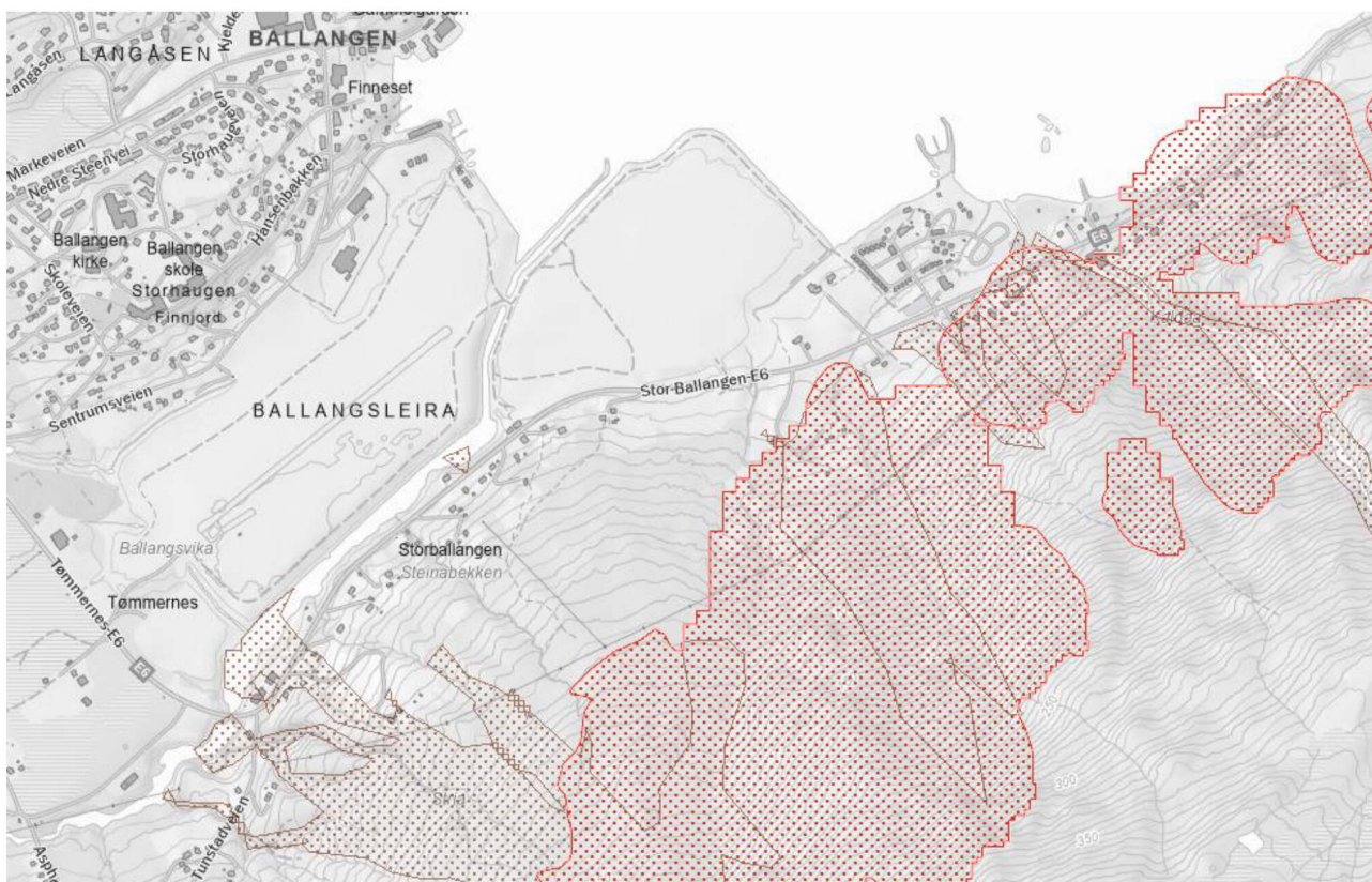
Figur 4-1 - Kartutsnitt over registrerte aktsomhetsområder for skred. Kilde NVE Atlas (rød skravur - snøskred, brun skravur jord og flomskred).
