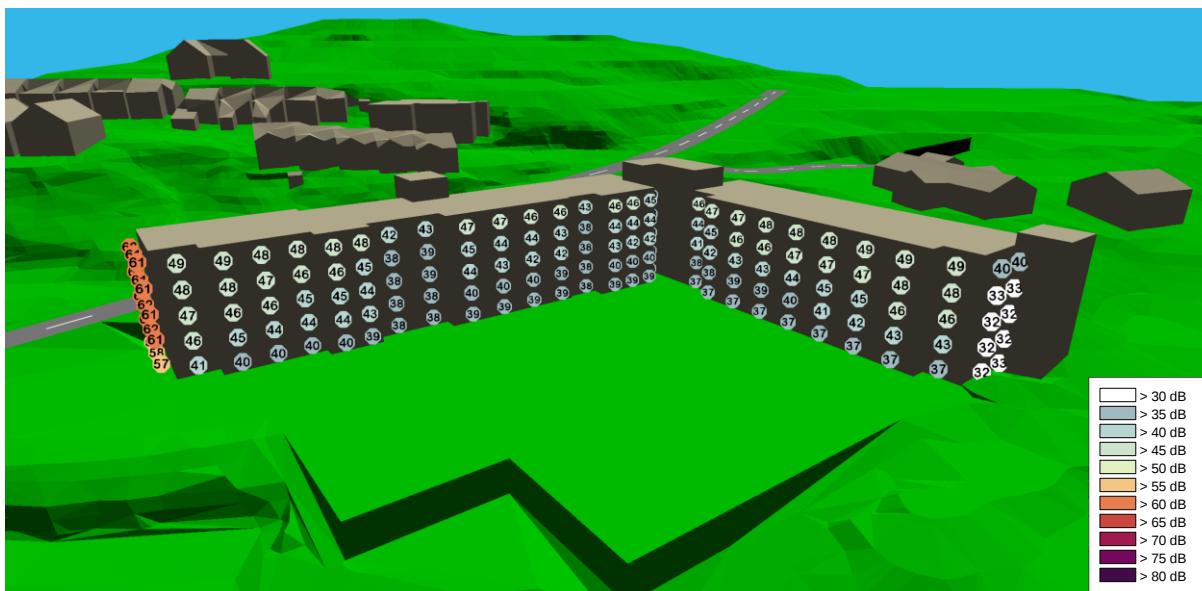
Figur 7: Fasadenivåer L_{den} fra vegtrafikk, sett fra nord. Grenseverdi er L_{den} \leq 55 dB for vegtrafikk.
