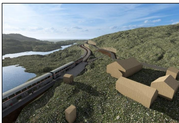
Figur 4.26: Utsnitt fra 3D-modell som viser driftsveg og spor sett i retning Søsterbekk.
