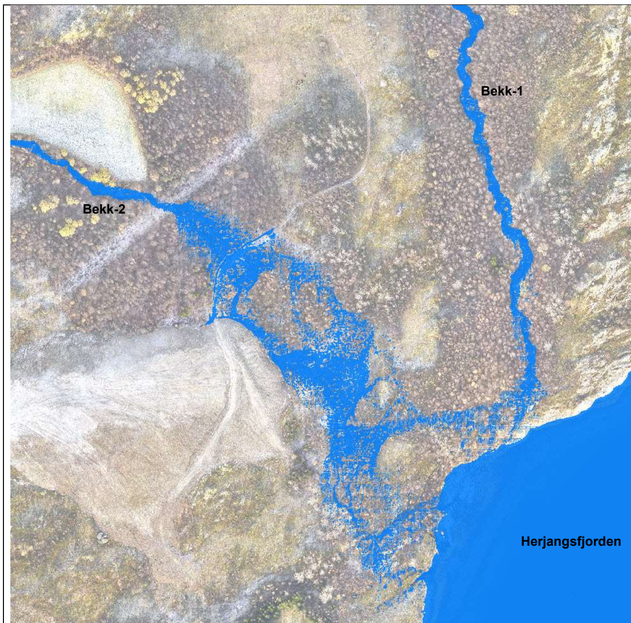
Figur 31: Flomutbredelse ved utbyggingsområdet på Lallasletta (1000-årsflom med 40% klimapåslag), (se flomsonekart i Vedlegg 5).
