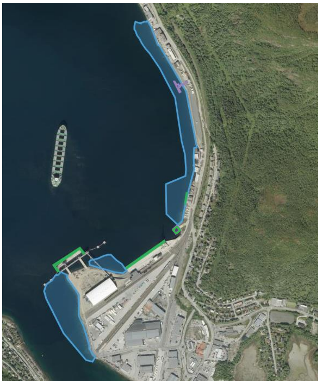
Figur 5: Oversikt over nærliggende kaianlegg (grønn markering) ved utviklingsområdet markert blått. Lilla markering viser tidligere kaianlegg som ikke finnes i dag. Kilde: Gislink (Kartverket, Geovekst, kommuner – Geodata AS)
