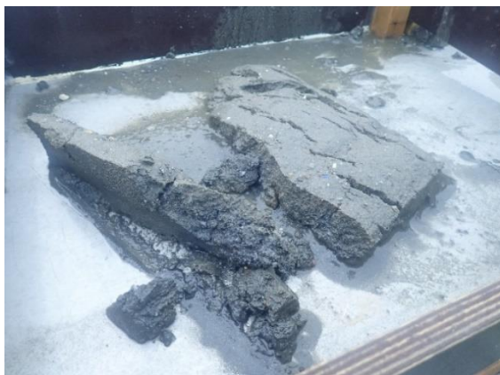
Figur 10: Grabbprøve fra sedimentstasjon St12 dominert av sand med innslag av noe grus og avfall i form av plast. Kilde: Rambøll, 25. januar 2022.
