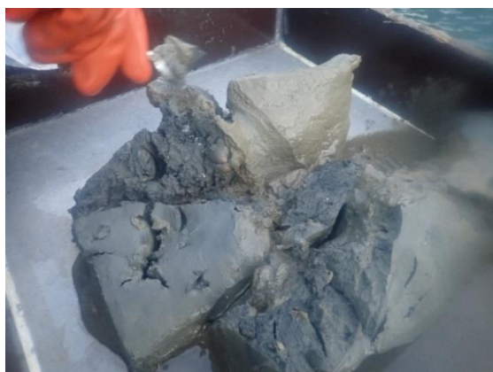
Figur 8: Grabbprøve fra sedimentstasjon St1 dominert av silt/leire med innslag av skjellrester. Foto: Rambøll, 27. januar 2022.
