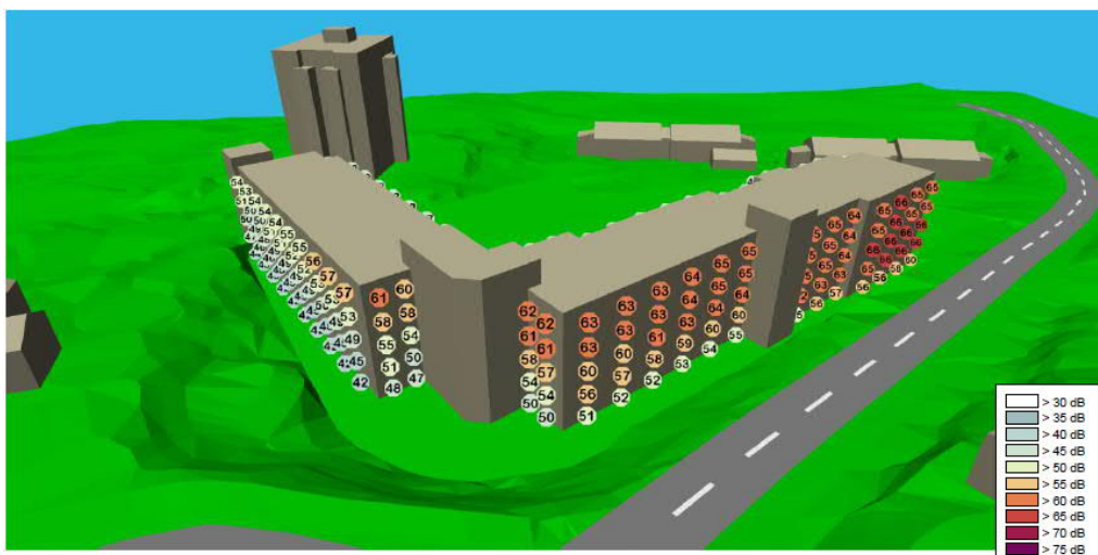
Figur 34: Fasadenivåer Lden fra vegtrafikk, sett fra sør. Grenseverdi er Lden \leq 55 dB for vegtrafikk. Kilde: Multiconsult.
