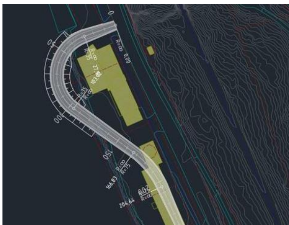
Figur 27: Atkomst som hensyntar Fagmøbler-bygget og utfylling Agenda. Alternativet hensyntar ikke behov for laste- og lossearealer ved de nye sporene.
