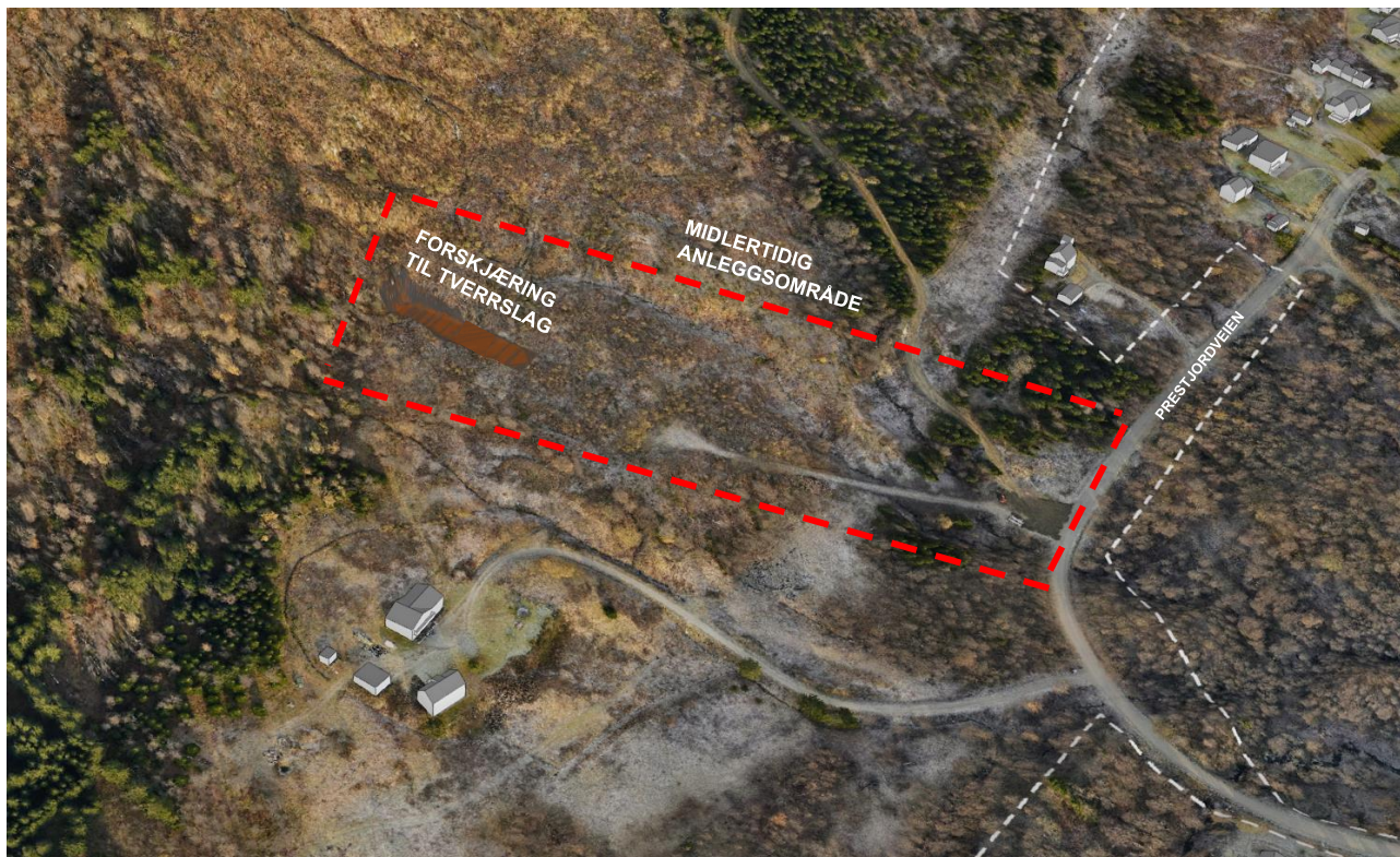
Figur 2-20: Område for tverrslag og midlertidig riggområde ved Vollan markert med rød stiplede linje.
