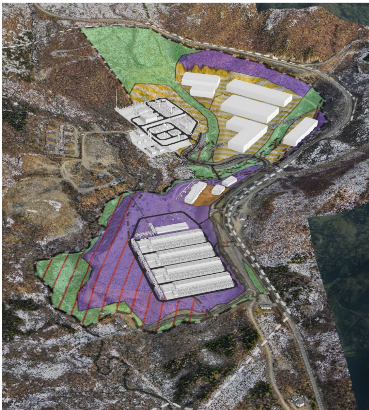
Figur 2-3: Skisse som viser foreslått arealbruk med hensyn til gjeldende reguleringsplan. Området for hydrogenproduksjon og annen industri er regulert til næringsbebyggelse (lilla farge) og kombinert bebyggelse- og anleggsformål (gul og hvit skravur). En del av området for ammoniakkproduksjon, rørgate og internevei mellom hydrogen- og ammoniakkanlegg og riggområde i sør omfattes ikke av gjeldende reguleringsplan.
