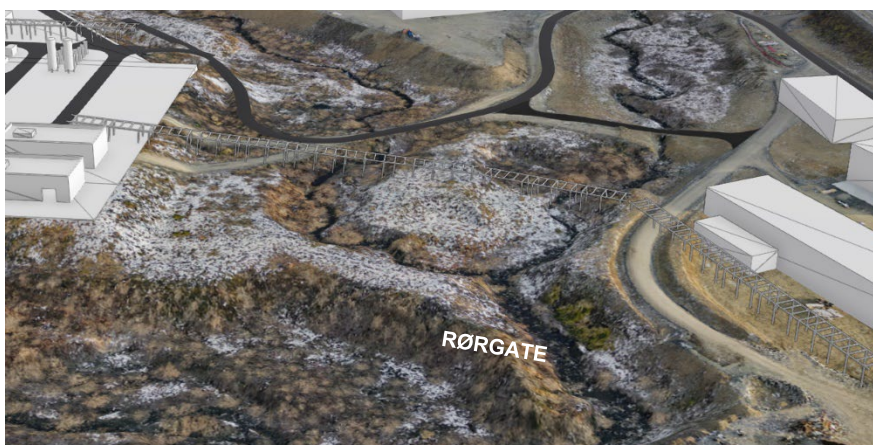
Figur 2-5: Rørgate mellom hydrogen- og ammoniakkanlegg
