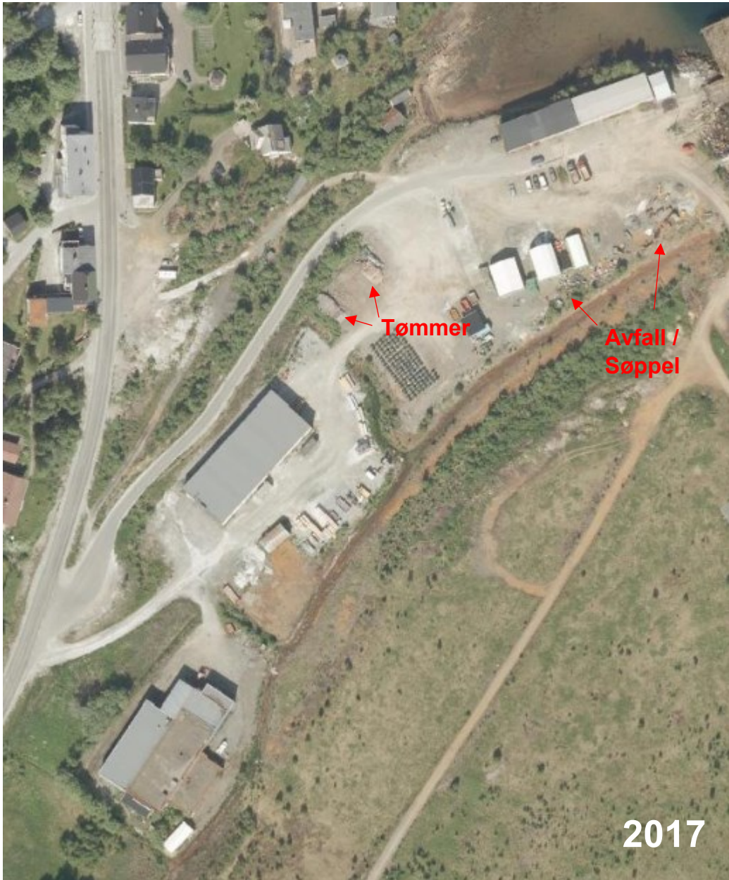
Figur 12. Mistanke om forurenset grunn i industriområde sørøst for Sentrumsveien. Flyfoto fra 2017. De røde pilene viser områder der det observeres avfall, fyllmasser, tømmer. Det kan også observeres lagring av diverse materialer på området. [11].
