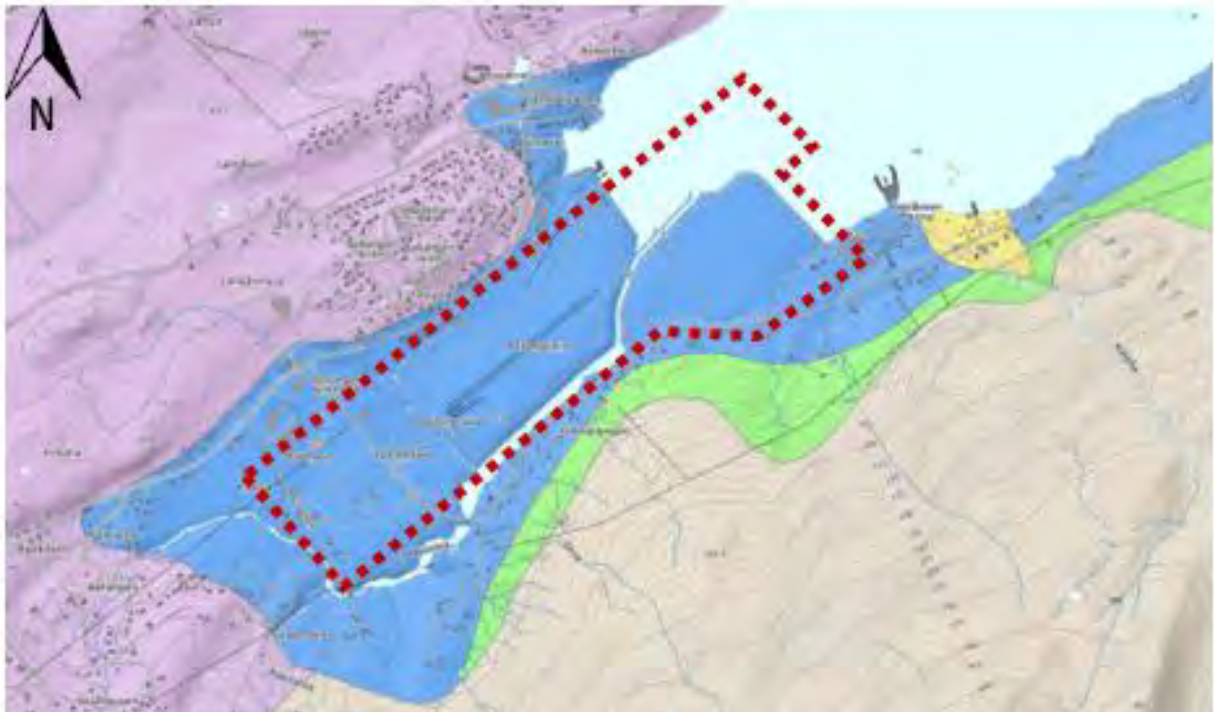
Figur 4-33: Utklipp av løsmassekart fra NGU (ngu.no) med omtrentlig plassering av foreslått utbygging markert med rødt. Marine avsetninger (i blått) dekker mesteparten av området. Breevavsetninger av usortert materiale
