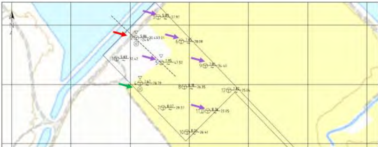
Figur 4-36: Grunnundersøkelser gjennomført av Sweco i 2021. Bekræftet sprøbruddsmateriale vist med rød pil, mistenkt sprøbruddsmateriale med lilla, prøve uten sprøbruddsegenskaper markert med grønt.
