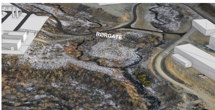
Figur 2-5: Rørgate mellom hydrogen- og ammoniakkanlegg
