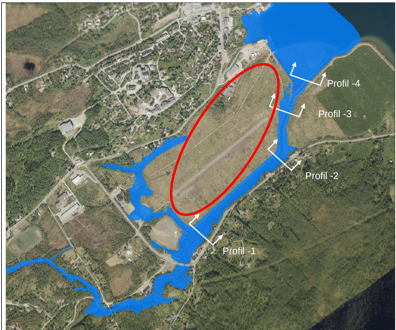
Figur 13: Flomutbredelse ved utbyggingsområdet på Ballangseira for PMF, utbyggingsområdet er vist med en rød oval.
