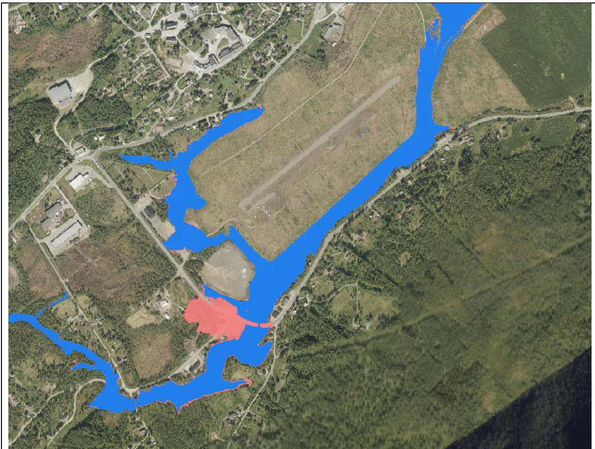
Figur 18: Økning i flomutbredelse (rosa farge) på grunn av tilstopping av B1 og B2 ved PMF.
