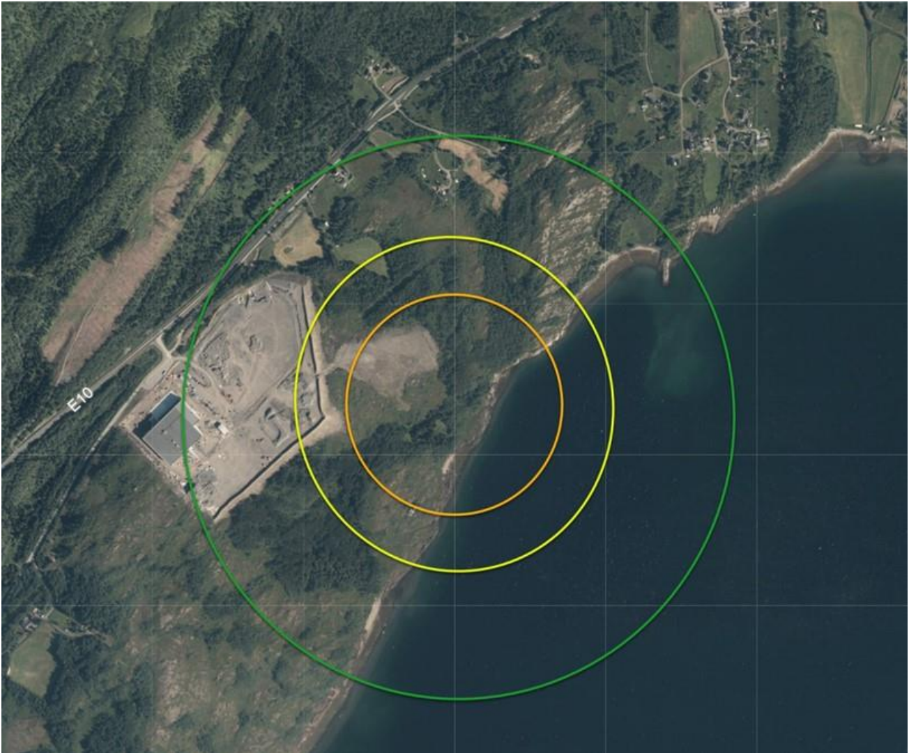
Figur 7-4: Fremstilling av resultatene fra innledende QRA på Lallasletta. Indre soner er markert med oransje linje, midtre med gul linje og ytre sone med grønn linje. Illustrasjon utarbeidet av Aker Narvik.
