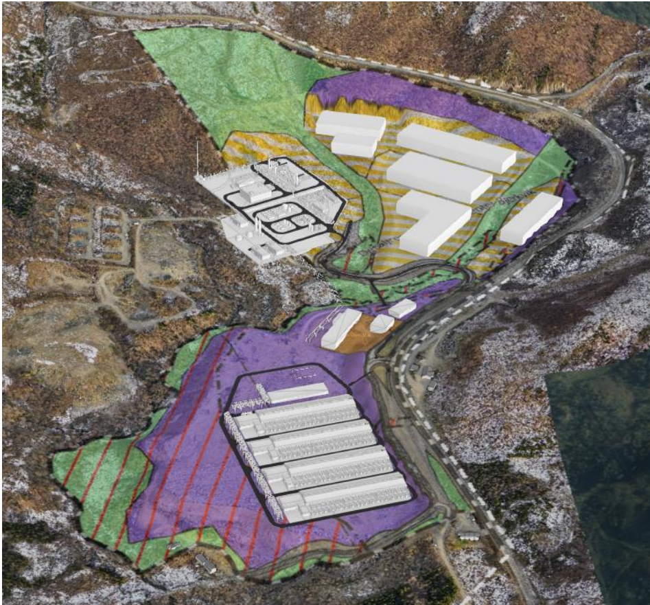
Figur 5-9: Skisse som viser foreslått arealbruk med hensyn til gjeldende reguleringsplan (Plan-ID 2019002). Området for hydrogenproduksjon og annen industri er regulert til næringsbebyggelse (lilla farge) og kombinert bebyggelse- og anleggsformål (gul og hvit skravur). En del av området for ammoniakkproduksjon, rørgate, nye internveier og riggområde i sør omfattes ikke av gjeldende reguleringsplan.
